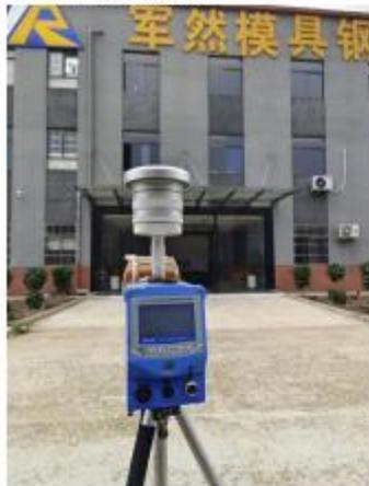
无组织废气现场监测照片
